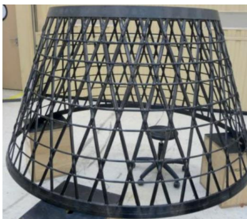
Рисунок 2. Сетчатая конструкция конического адаптера для РН Vega
