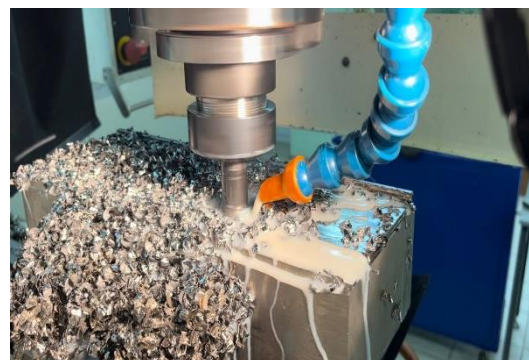
Рисунок 5. Концевая фреза и обработка титановой заготовки с СОЖ.
