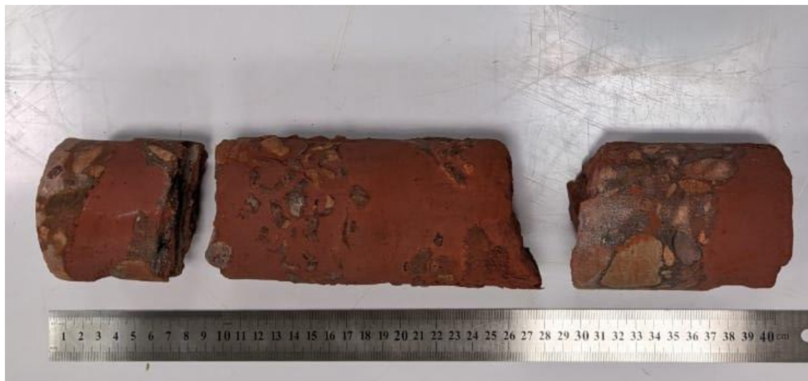
Рисунок 3 – Керн после инъектирования
