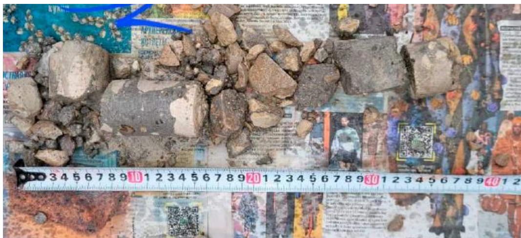
Рисунок 2 – Керн до инъектирования
