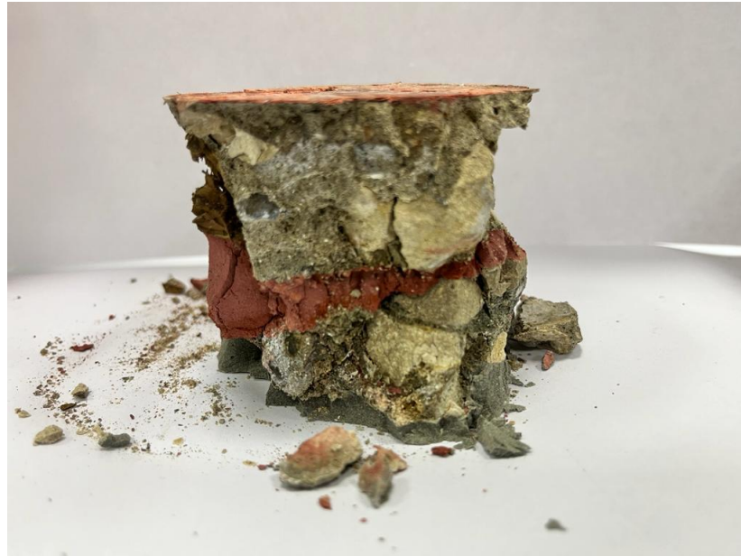
Рисунок 5 – Образец 4 после испытания на прочность
