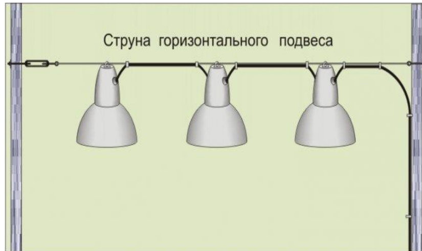
Рисунок 2.6. - Крепление на тросах
