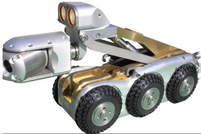
Рисунок 6. REVI 300 роботизированная система
