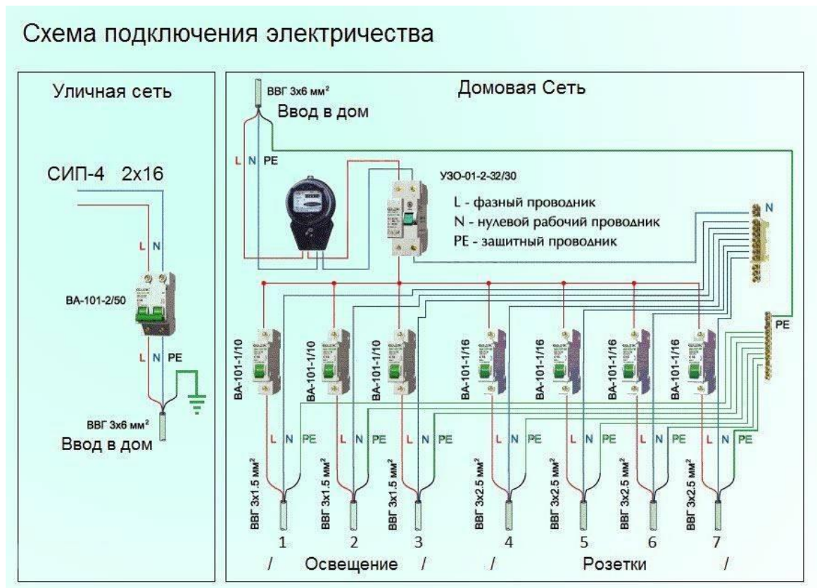
Рисунок 1.5. - Монтажная схема квартирной электросети.
