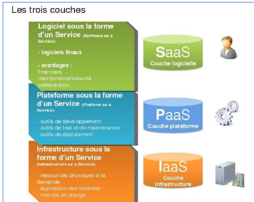
Figure 4: Les couches du Cloud computing
