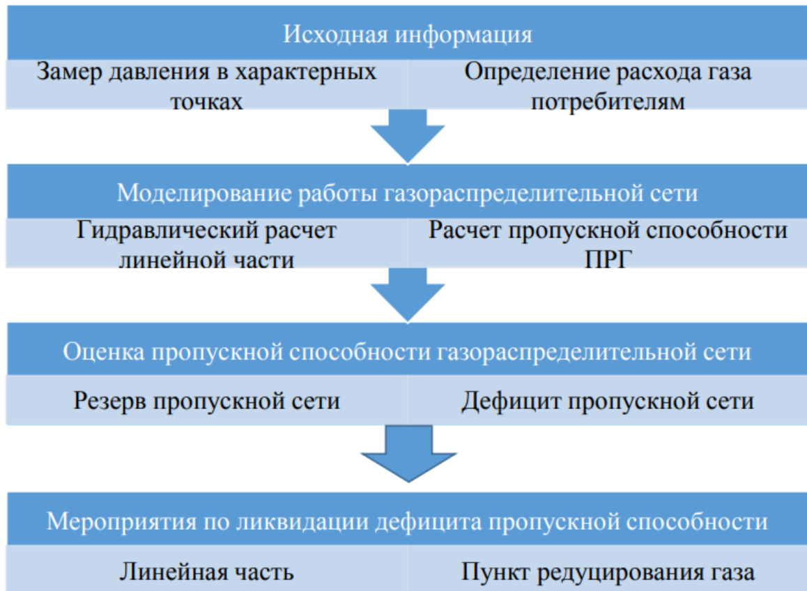
Рисунок 1 – Схема анализа пропускной способности газораспределительной сети [3]
