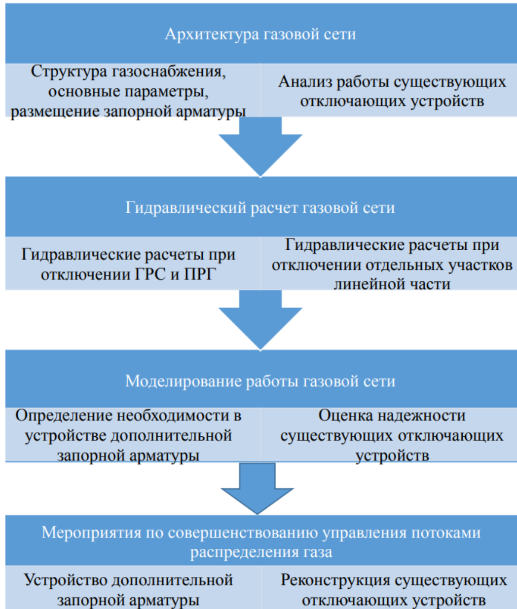
Рисунок 2 – Схема контроля надежности управлением потоками газа с использованием отключающих устройств [4]
