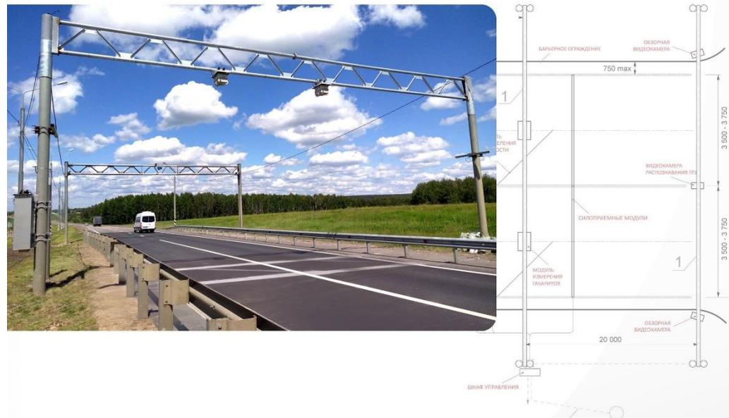
Рисунок 1 – общий вид автоматизированного пункта весогабаритного контроля
