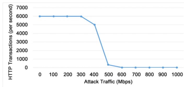
Рисунок 7 . HTTP-транзакции под атакой SMURF (сценарий 4: серверная ОС Mac на серверной платформе Apple).
