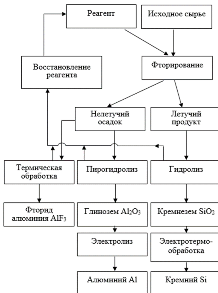
Рис. 1. Технологическая схема комплексной переработки каолиновых концентратов с извлечением алюминия, кремния и их соединений.
