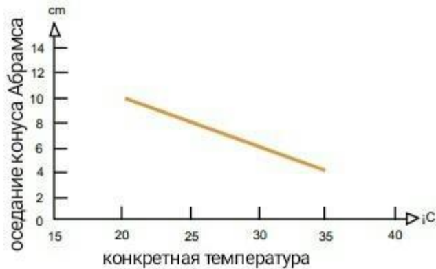
Рисунок 2 Подвижность бетонной смеси в зависимости от температуры [5]
