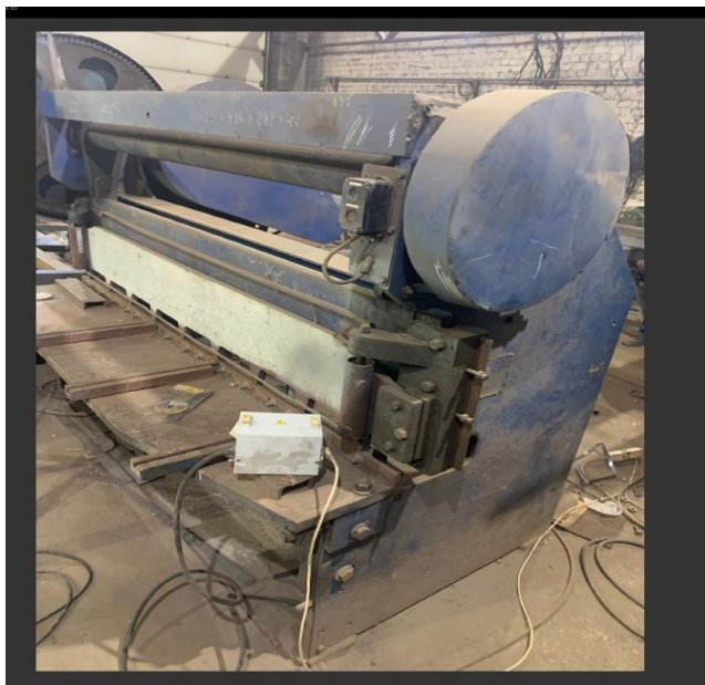
Рисунок 2 – Ножницы Кривошипные Н3118
